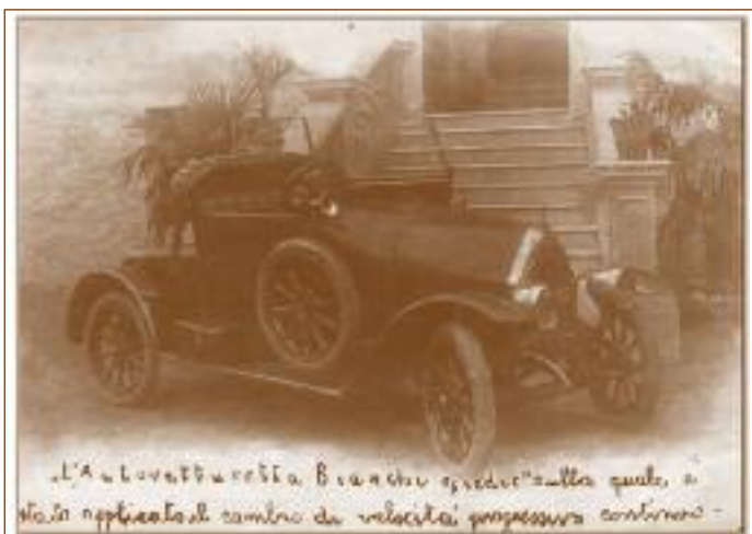
“L'autovetturetta Bianchi speeder” sulla quale è stato applicato il cambio di velocità progressivo continuo: nota autografa di Antonio Ciabattoni su un'immagine fotografica della vettura citata.
